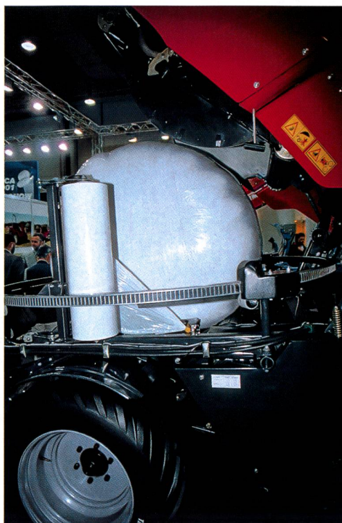
Presse à balles rondes de Kverneland, Allemagne, (Tarup) avec enrubanneuse incorporée.
