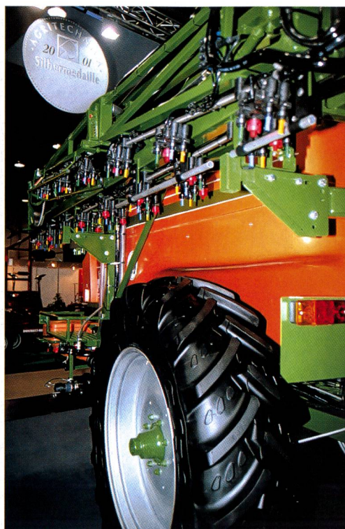
Buses Lechler: Rampe d'Amazone avec groupe de quatre buses, à enclencher en groupe ou isolément.
