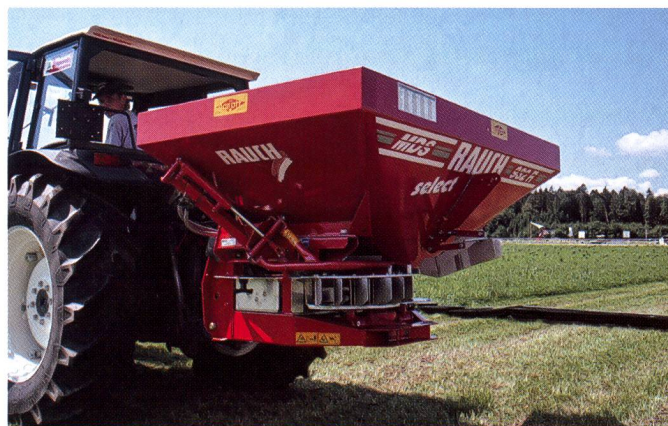
La limitation de l'épandage en bord de champ est d'autant plus importante sur les petites parcelles: Réglage marginal sans sortir des traces avec cette machine Rauch (photo: Sepp Föhn, conseiller en machinisme, EA Plantahof, Landquart).
