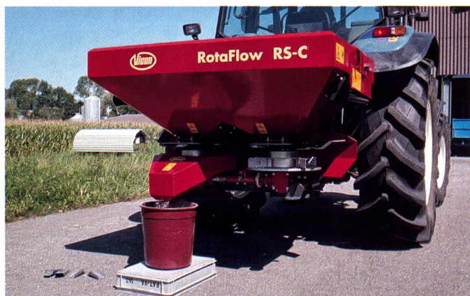
Le test de rotation et le tableau de réglage sont deux outils indispensables pour un épandage d'engrais adapté aux besoins (photo Paul Mürli).
