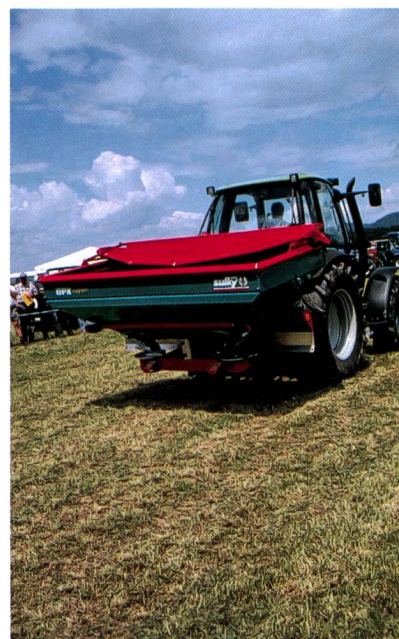
Machines avec dispositif de pesage électronique et régulation automatique du débit selon la vitesse. Le surcroît de confort et de précision d'épandage est payé cher. (photos: Ueli Zweifel)
