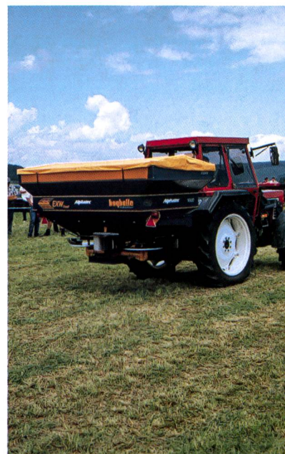
Machines avec dispositif de pesage électronique et régulation automatique du débit selon la vitesse. Le surcroît de confort et de précision d'épandage est payé cher. (photos: Ueli Zweifel)
