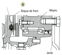
Freins à disques à bain d'huile placés sur le moyeu d'une roue avant.
