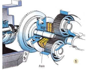
Freins à disques multiples à bain d'huile, placés sur l'axe de transmission en sortie de boîte.
