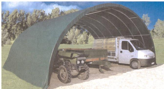
d'utilisation. Il est livrable avec ou sans pignon plein ou avec une porte. La couverture du TOUTABRI est en principe proposée avec de la bâche camion garantie 10 ans. Une couverture en film plastique peut également être envisagée. La construction du TOUTABRI a été étudiée sur les bases et expériences des serres. La technique d'assemblage fait appel à un procédé breveté d'assemblage des entretoises
