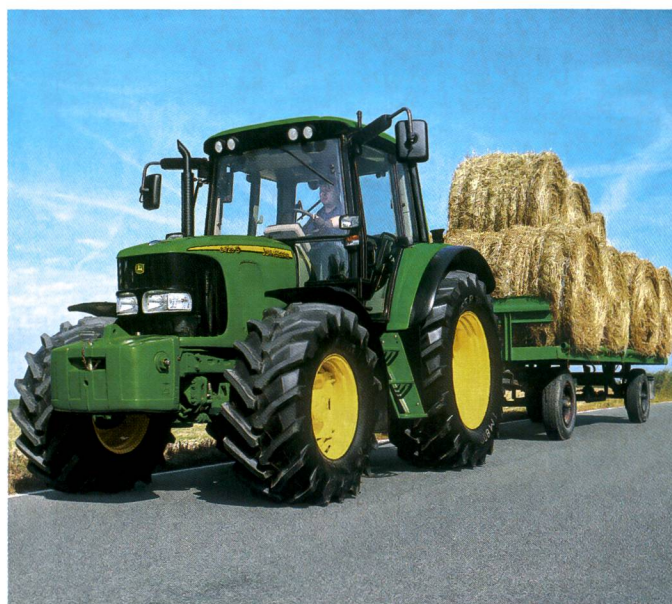
Les outils de travail frontaux et arrières requièrent toute l'attention du conducteur. La transmission en continu lui évite les changements de rapport et permet l'adaptation exacte de la vitesse.
