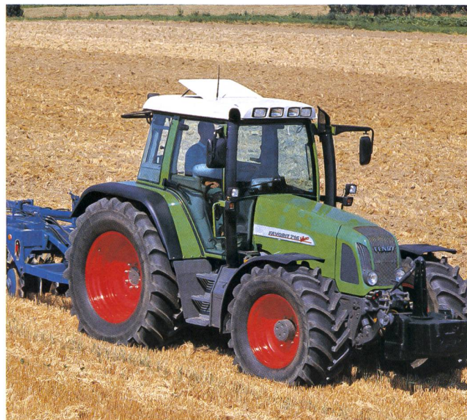
Lors de trajets routiers, le système Varion de Fendt permet de rouler à vitesse maximale avec un nombre de tours réduit (photo: Fendt).
