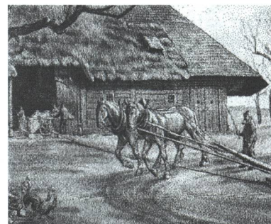
Jour de battage vers 1900: une batteuse fonctionne par un manège actionné par des chevaux. Ce système était aussi utilisé dans les mines.
