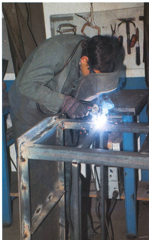
Le soudage à courant continu remplit toutes les exigences des techniques de soudure dans le secteur agricole et pourtant...
