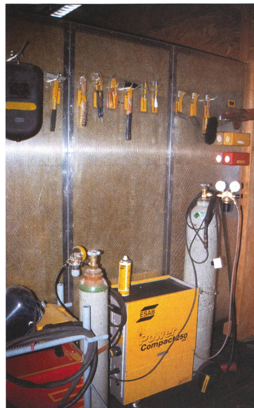
... bon nombre d'utilisateurs se décident pour une installation de soudure au fil qui est plus facile à maîtriser que la soudure à l'arc.
