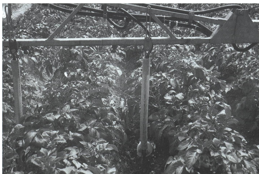
Fig. 6: Les supports de buses, suspendus sur ressorts sont réglables horizontalement et verticalement sur la perche du pulvérisateur (Fischer, prototype 2). A droite: le dispositif de protection de la buse, en forme de cône, s'est avéré satisfaisant, mais doit encore être amélioré.
