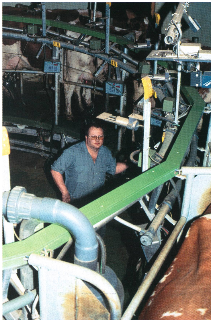
Jouer la carte de la production laitière implique tôt ou tard d'investir dans une nouvelle technologie de traite. Le carrousel est l'une des diverses solutions pour les conditions suisses, soit des grands troupeaux.
