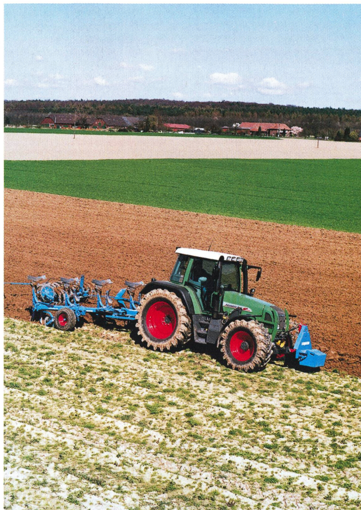
Interface entre tracteur et machine, par exemple charrue commandée par électronique au moyen du joystick Fendt.
