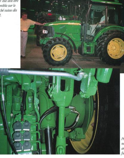
Prototype de la nouvelle suspension arrière pour la future série 8020.
