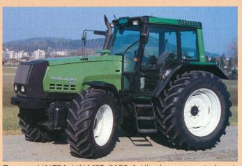
Tracteur VALTRA VALMET 8150-4 Hitech, moteur turbo six cylindres, 92 kW (125 CV), transmission à 3 paliers de charge, suspension avant, poids 5590 kg (prix catalogue: Fr. 117 850.–), rapport de test n° 1817/01.
