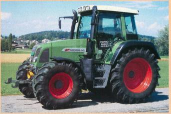
Tracteur FENDT Farmer 410 Vario, moteur turbo quatre cylindres, quatre soupapes et refroidissement d'air de suralimentation, 74 kW (100 CV), transmission en continu à deux plages de vitesse, hydraulique et prise de force frontales, suspension avant, suspension de la cabine, poids 5420 kg (prix catalogue: Fr. 142 098.–), rapport de test n° 1814/00.
