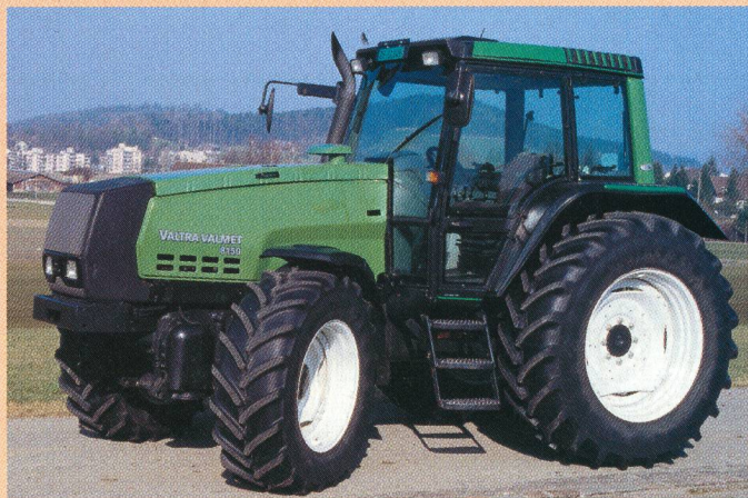
Tracteur VALTRA VALMET 8150-4 Hitech, moteur turbo six cylindres, 92 kW (125 CV), transmission à 3 paliers de charge, suspension avant, poids 5590 kg (prix catalogue: Fr. 117 850.-), rapport de test n° 1817/01.
