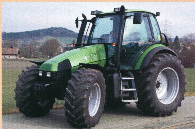
Tracteur DEUTZ-FAHR Agroton 135 MK3, moteur turbo six cylindres, 99 kW (135 CV), transmission à 4 paliers de charge, suspension avant, suspension de la cabine, poids 6160 kg (prix catalogue: Fr. 132 950.-), rapport de test n° 1822/01.
