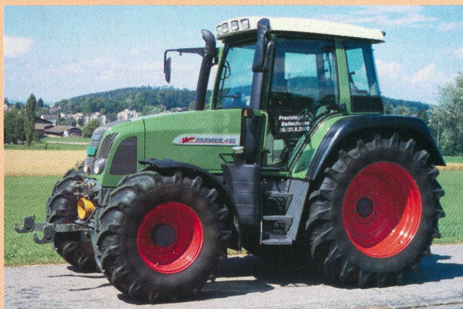
Tracteur FENDT Farmer 410 Vario, moteur turbo quatre cylindres, quatre soupapes et refroidissement d'air de suralimentation, 74 kW (100 CV), transmission en continu à deux plages de vitesses, hydraulique et prise de force frontales, suspension avant, suspension de la cabine, poids 5420 kg (prix catalogue: Fr. 142 098.-), rapport de test n° 1814/00.
