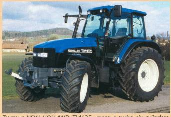
Tracteur NEW HOLLAND TM135, moteur turbo six cylindres, 93 kW (125 CV), transmission à 6 paliers de charge, 3 groupes, hydraulique frontale, suspension avant, suspension de la cabine, poids 6340 kg
