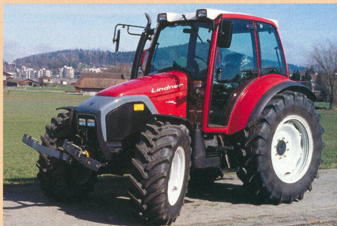
Tracteur LINDNER Geotrac 100, moteur turbo quatre cylindres, 72 kW (98 CV), transmission à 2 paliers de charge, hydraulique et prise de force frontales, poids 4070 kg (prix catalogue: Fr. 86 260.-), rapport de test n° 1827/01.
