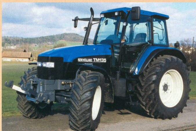
Tracteur NEW HOLLAND TM135, moteur turbo six cylindres, 93 kW (125 CV), transmission à 6 paliers de charge, 3 groupes, hydraulique frontale, suspension avant, suspension de la cabine, poids 6340 kg (prix catalogue: Fr. 123 603.-), rapport de test n° 1824/01.
