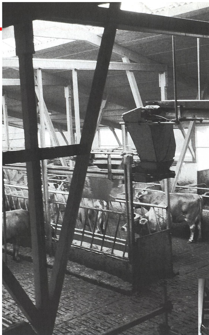
Malaxeur à fourrage (image de droite) et tapis roulant qui achemine le fourrage au centre de l'étable (image de gauche). Un disque rotatif pivotant «balaie» le fourrage par le canal dans le râtelier.
