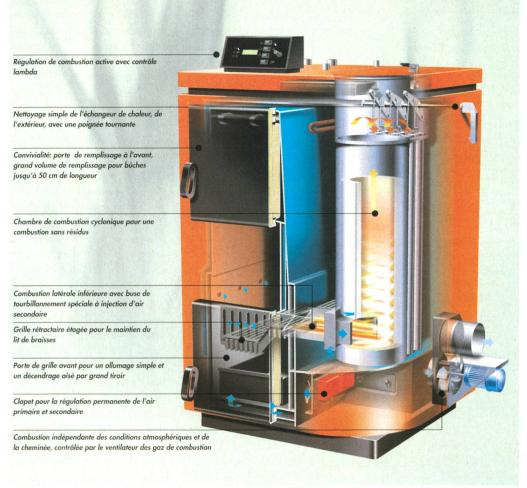
Coupe d'une chaudière à bûches «Cyclotronic» de Schmid, Eschlikon.
