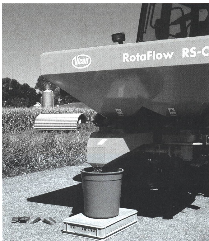
Une évidence avec les semoirs, encore trop rare avec les distributeurs d'engrais! Le contrôle du débit doit être effectué à chaque changement d'engrais et au minimum une fois par an.
