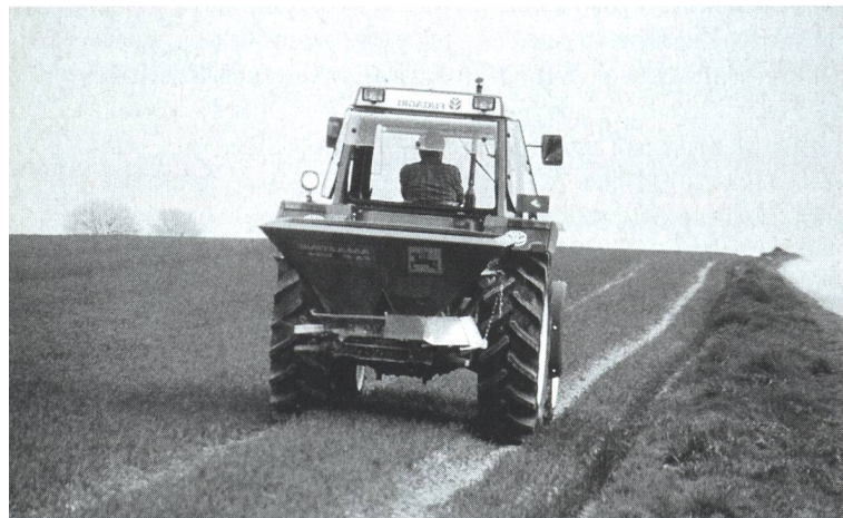
Afin d'éviter l'épandage inutile d'engrais en bordure de champ, il convient d'utiliser un écran d'épandage. Celui-ci fait partie de l'équipement de base des distributeurs d'engrais modernes.
