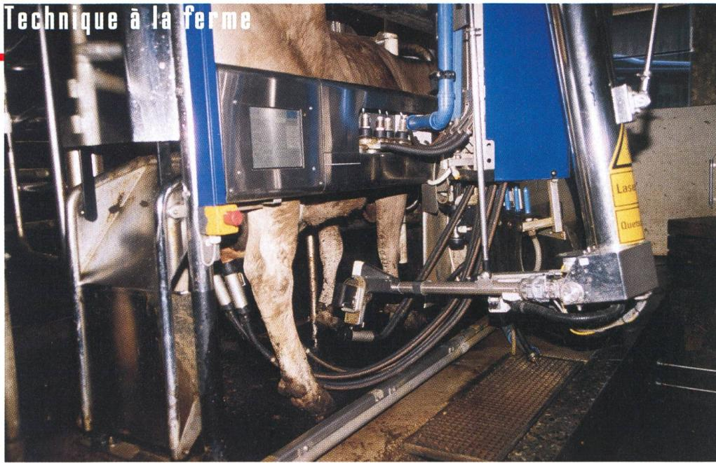
Après le nettoyage à l'aide d'un gobelet séparé (à droite), le bras trayeur doté d'une caméra repère chaque trayon au laser. De même, les gobelets se décrochent individuellement suite à la diminution du flux. Chaque trayon est désinfecté par un jet très fin disposé sur le bras. Ce même bras soutient les conduites pendant la traite à la façon d'une main ouverte.
