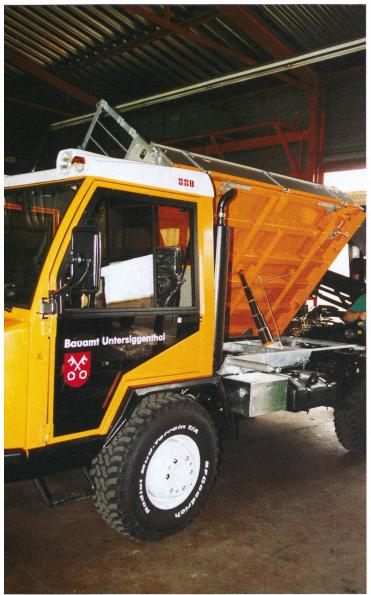
Les machines pour travaux de voirie sont construites selon des plans de construction analogues à ceux des machines agricoles qui sont équipées d'éléments propres à une clientèle ciblée, surtout pour le confort. On remarquera aussi le compromis consenti quant au profil des pneumatiques.
