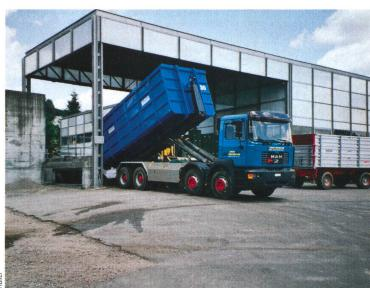
Le système de bennes interchangeables offre une solution intéressante pour passer des transports agricoles aux transports industriels.
