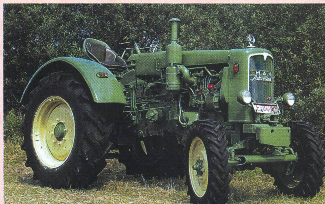
MAN-4-roues motrices AS 330 A (30 CV) avec suspension de l'essieu avant. Production dès 1950.
