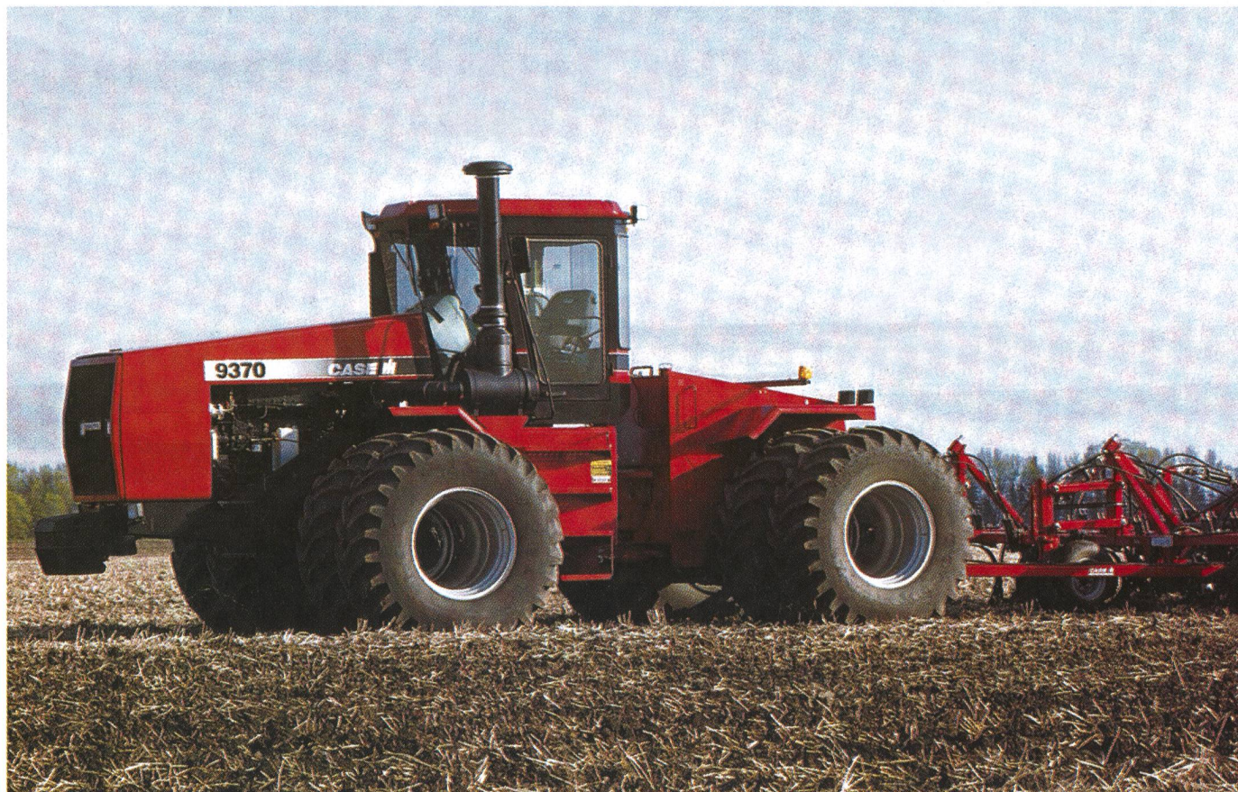
Tracteur 4-roues motrices classique: Case IH Steiger 9370 avec 360 CV.
