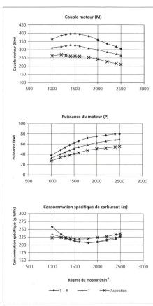
Fig. 4: Courbes de régime à pleine charge du couple moteur, de la puissance et de la consommation spécifique de carburant relevées dans les versions de moteur à aspiration avec turbocompresseur T et système supplémentaire de refroidissement d'air de suralimentation R.
