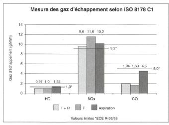
Fig. 9: Les gaz d'échappement sont mesurés selon un cycle de huit phases conformément à la norme ISO-8178 C1. Les gaz d'échappement dits limités, hydrocarbure (HC), oxyde nitrique (NOx) et monoxyde de carbone (CO) sont indiqués en g/kWh à titre de facteurs d'émissions.
