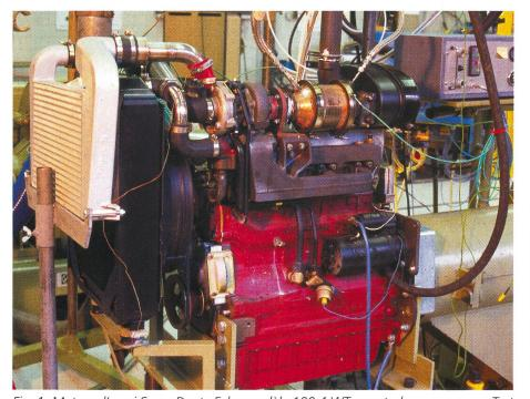
Fig. 1: Moteur d'essai Same Deutz-Fahr, modèle 100.4 WT avec turbocompresseur T et refroidisseur d'air de suralimentation R sur le banc d'essai de la FAT.
