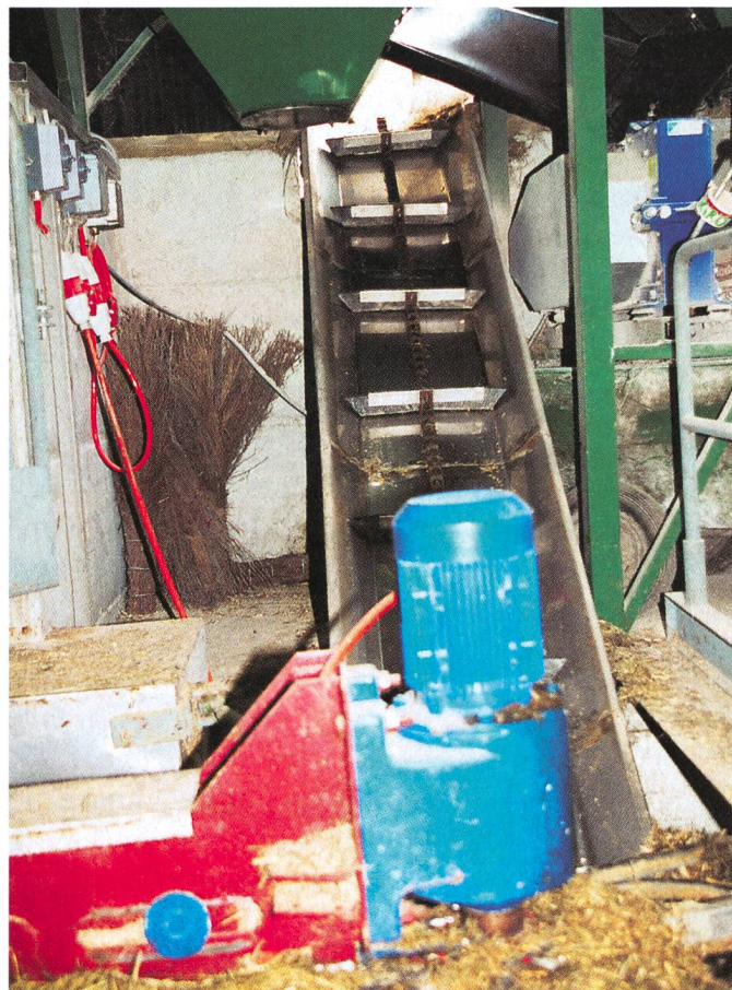
Convoyeur à bottes et moteur de l'ex-racleur recyclés, ou comment nettoyer la table d'affouragement.
