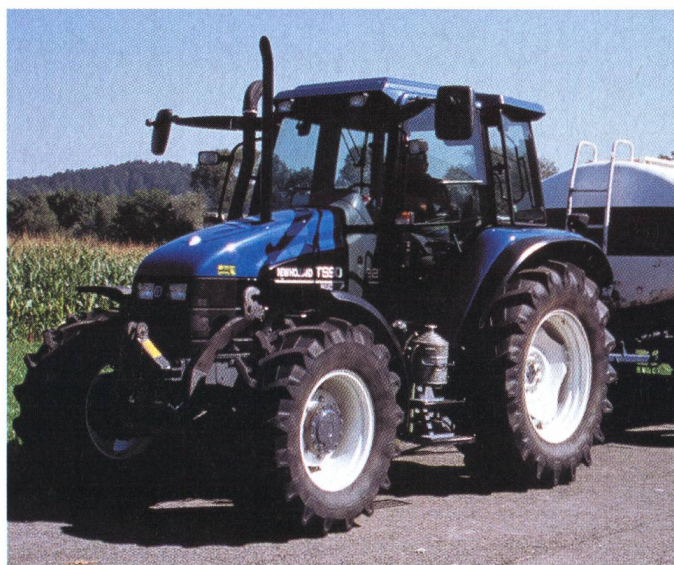
Le tracteur comparé New Holland TS 90 Turbo. Les quatre rapports de transmission sous charge peuvent être passés deux fois avec une seule pression sur la pédale d'embrayage. Le groupe de route permet ainsi de passer de 9,9 à 39,8 km/h.
