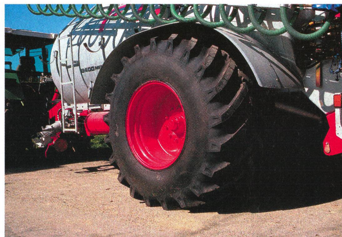
Roues spéciales encastrées dans la citerne. De plus en plus de constructeurs offrent ce modèle qui permet de monter les pneus larges sans dépasser la largeur maximale autorisée par la loi.
