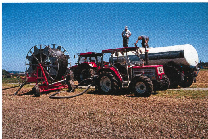
Les systèmes de purinage par tuyau ménagent bien les sols et sont très performants. Cependant, les frais qu'entraînent les tracteurs, les machines et le personnel sont considérables vu qu'il faut installer une station intermédiaire en bordure de champ.
