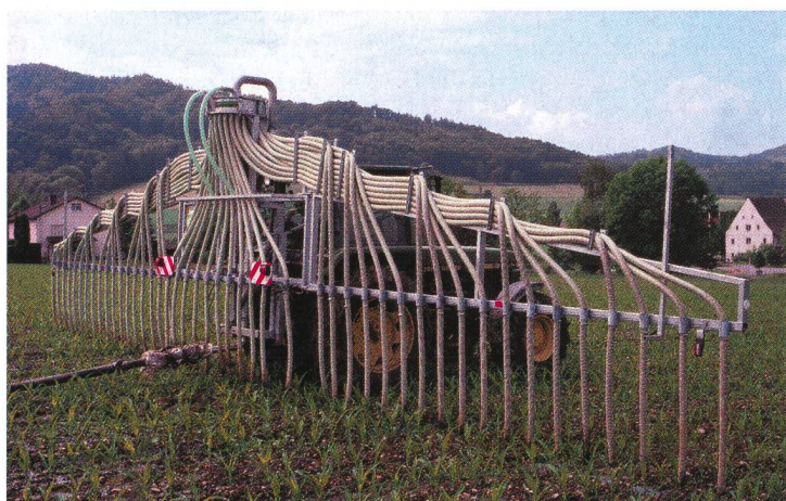
Les rampes d'épandage montées à l'arrière du tracteur permettent une application de lisier qui ménage le sol avec une répartition exacte en limitant les pertes d'azote par volatilisation.
