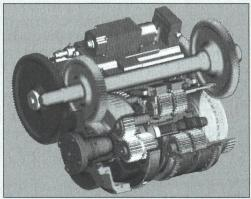
Huiles de boîtes de vitesses: les additifs évitent que le film lubrifiant protecteur ne se coince en bordure des engrenages et que les parties métalliques ne subissent des frottements.
