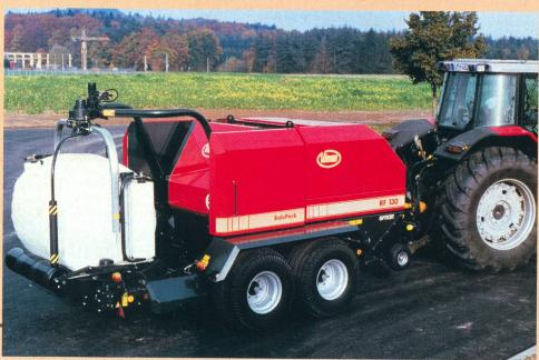
Vicon RF 130 BalePack, combinaison entièrement automatique de presse-enrubanneuse. La presse peut également être utilisée sans l'enrubanneuse. Photos d'usine
