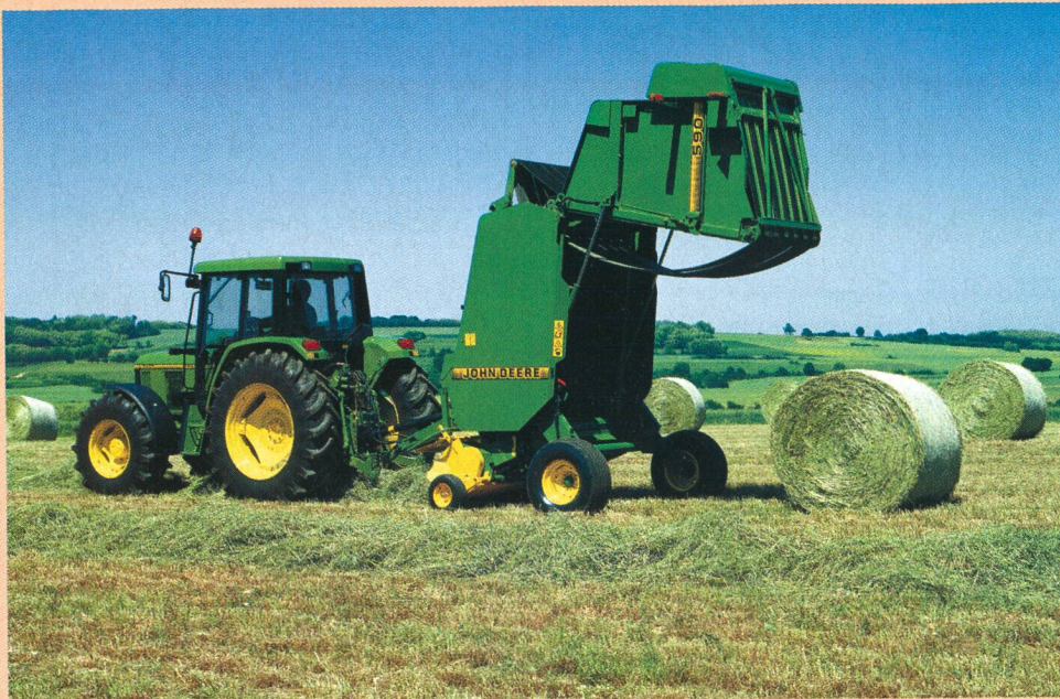
La presse Vario 590 de John Deere se trouve maintenant sur le marché avec un pick-up de 2 m et un dispositif de coupe à 14 couteaux.
