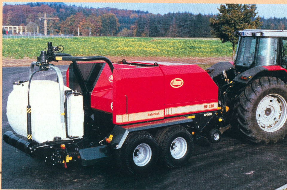
Vicom RF 130 BalePack, combinaison entièrement automatique de presse-enrubanneuse. La presse peut également être utilisée sans l'enrubanneuse.
