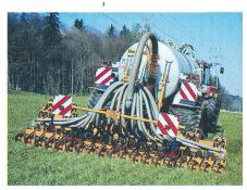
Ces enfouisseurs disposent en général de 10 à 24 disques espacés de 20 à 25 cm qui déposent le purin à une profondeur de 4 à 10 cm.
