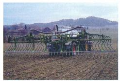
Dispositif d'épandage à tuyaux souples de 12 m de largeur de travail.
