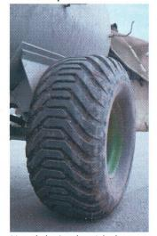
Une règle simple est à observer pour l'équipement en pneumatiques des citernes à pression: celles-ci devraient être équipées de pneus dont la pression maximum de 2 bar doit assurer une capacité de charge suffisante à la vitesse que l'on a choisie.
