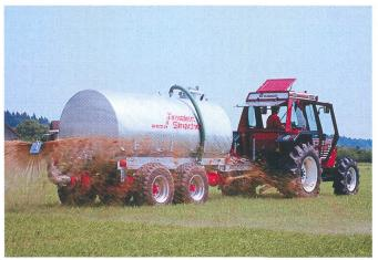
Citerne conventionnelle de 8000 litres avec répartiteur à tête «déflectrice» et essieu tandem. Ce système de répartiteur a l'avantage de travailler avec plus de précision en début et fin de parcelle. Pour 4000 m³ épandus annuellement: coût avec traction et M.O. CHF 4,18/m³.
