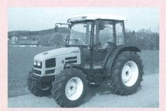
Tracteur HÜRLIMANN XA 656, moteur turbo trois cylindres, 46 kW (63 CV), transmission à 3 paliers de charge, poids 2830 kg (prix catalogue: Fr. 61 200.-), rapport de test nº 1809/00.
