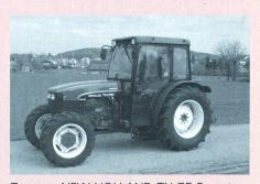
Tracteur NEW HOLLAND TN 75 F, moteur à aspiration quatre cylindres, 56 kW (76 CV), transmission à 2 paliers de charge, essieu avant SuperSteer, poids 2810 kg, (prix catalogue: Fr. 71 800.-), rapport de test nº 1812/00.
