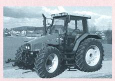
Tracteur MASSEY FERGUSON 6255, moteur turbo quatre cylindres, 70 kW (95 CV), transmission à 4 paliers de charge, hydraulique et prise de force frontales, poids 4870 kg (prix catalogue: Fr. 106 425.-), rapport de test n° 1803/00.
