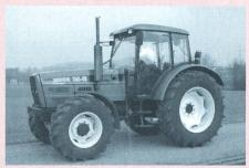
Tracteur ZETOR 116 41, moteur à aspiration, six cylindres, 81 kW (110 CV), transmission à 3 paliers de charge, poids 4610 kg, (prix catalogue: Fr. 95 138.-), rapport de test nº 1802/00.
