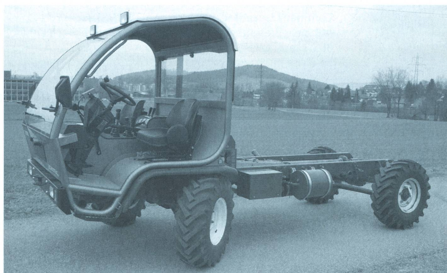
Fig. 1: Transporteur SCHILTRAC 2068 (version 40 km/h), moteur turbo quatre cylindres, 61 kW (83 CV), transmission à deux paliers de charge, poids à vide 2180 kg, poids total autorisé 7000 kg (prix catalogue Fr. 78 200.-), rapport de test transporteur FAT n° 1797/00. Les méthodes de tests techniques en Suisse et en Autriche ont été harmonisées, ce qui permet d'échanger les résultats d'un pays à l'autre.
