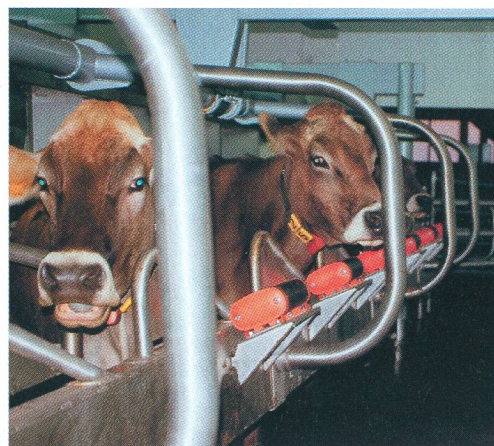
Les barres s'adaptent à la taille des animaux et se lèvent après la traite pour les libérer du box.
