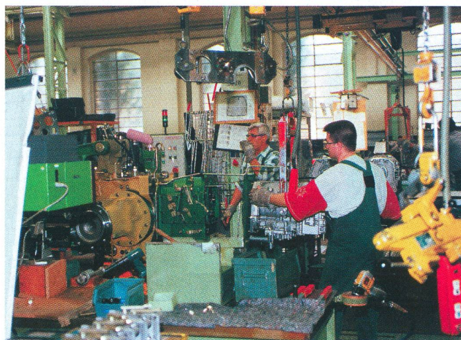
Construction de la série 6010 dans les halles traditionnelles de montage des usines John Deere à Mannheim. Après une balte à 75 stations, les éléments préfabriqués, entraînés par un tapis roulant, deviendront tracteurs après 5 heures d'assemblage.
