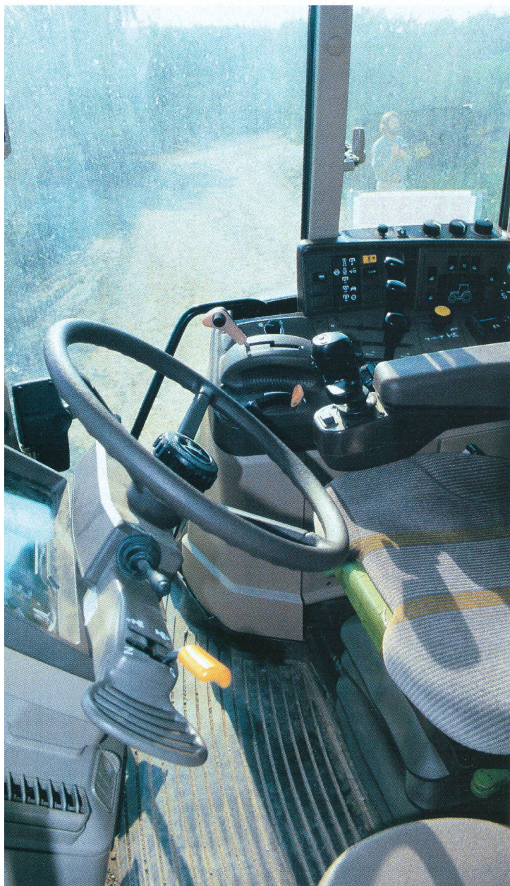
John Deere vise la continuité: l'AutoPowr – la cabine du conducteur a subi peu de modifications. Les deux éléments principaux de l'inverseur Powr: le réglage de l'arrêt au premier plan et le compteur de vitesse programmable au second plan. Visible aussi sur l'image, le bouton pour régler la puissance du régime.
