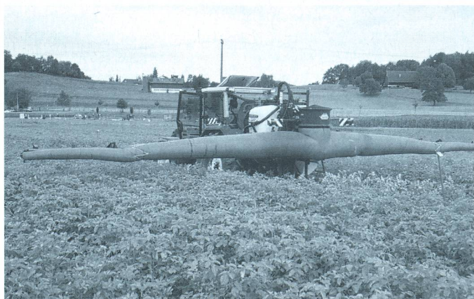
Fig. 2: L'assistance pneumatique fournie par une souffleuse axiale améliore la pénétration dans la culture et réduit la dispersion.
