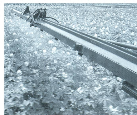
Fig. 5: Les buses à injection d'air produisent des bulles remplies d'air, qui sous l'effet d'accélération dû à la pression (9 bar) pénètrent en profondeur dans la végétation. Gauche/Droite: Buses à jet plat à injection d'air, individuelles/doubles.
