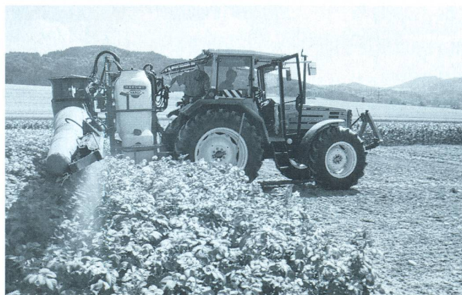
Fig. 2: L'assistance pneumatique fournie par une souffleuse axiale améliore la pénétration dans la culture et réduit la dispersion.
