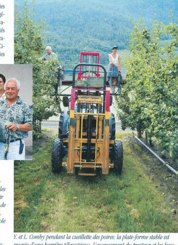
Y. et L. Comby pendant la cueillette des poires: la plate-forme stable est munie d'une barrière télescopique. L'avancement du tracteur et les fonctions de la plate-forme se règlent depuis le haut.
