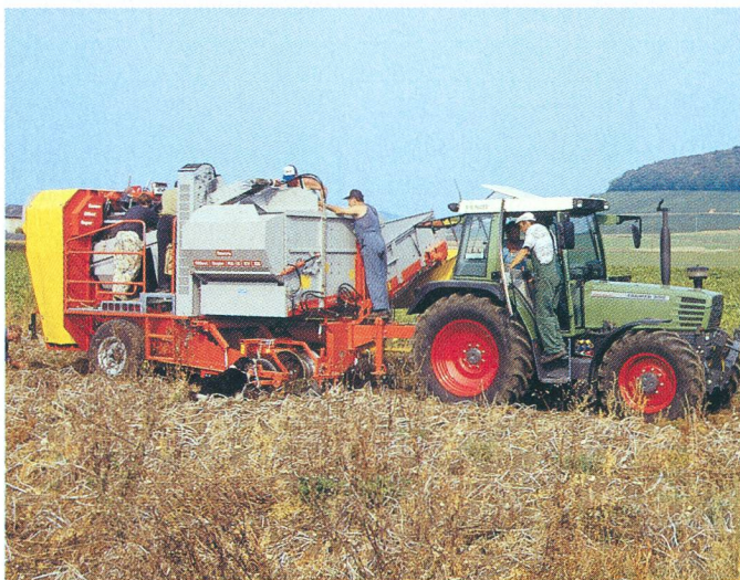
La récolteuse totale de pommes de terre à deux rangs est très performante. Elle n'est cependant rentable que lorsque les buttes comportent peu de pierres et de mottes.
