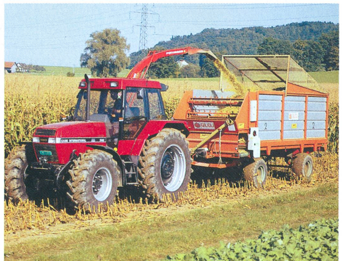
La performance à la surface d'une ensileuse à maïs portée dépend en premier lieu de la puissance du tracteur. Lorsque les tracteurs sont suffisamment puissants, les ensileuses à maïs portées peuvent s'avérer très compétitives.
