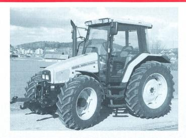
MOTEUR Perkins 1004-40 T (AK 31354) Injection directe avec turbo-compresseur. Alésage/course 100/127 mm. Cylindres/cylindrée 4/3990 cm³. Refroidissement à eau, ventilateur à coupleur viscothermostatique. Capacité réservoir carburant 160 litres. Puissance nominale 70 kW (95 CV) (indication du constructeur). Régime nominal 2200 min⁻¹.
