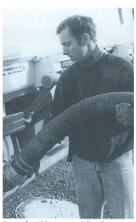
Le combustible est pompé dans le silo en quelques minutes à l'aide d'un tuyau et d'air comprimé.
