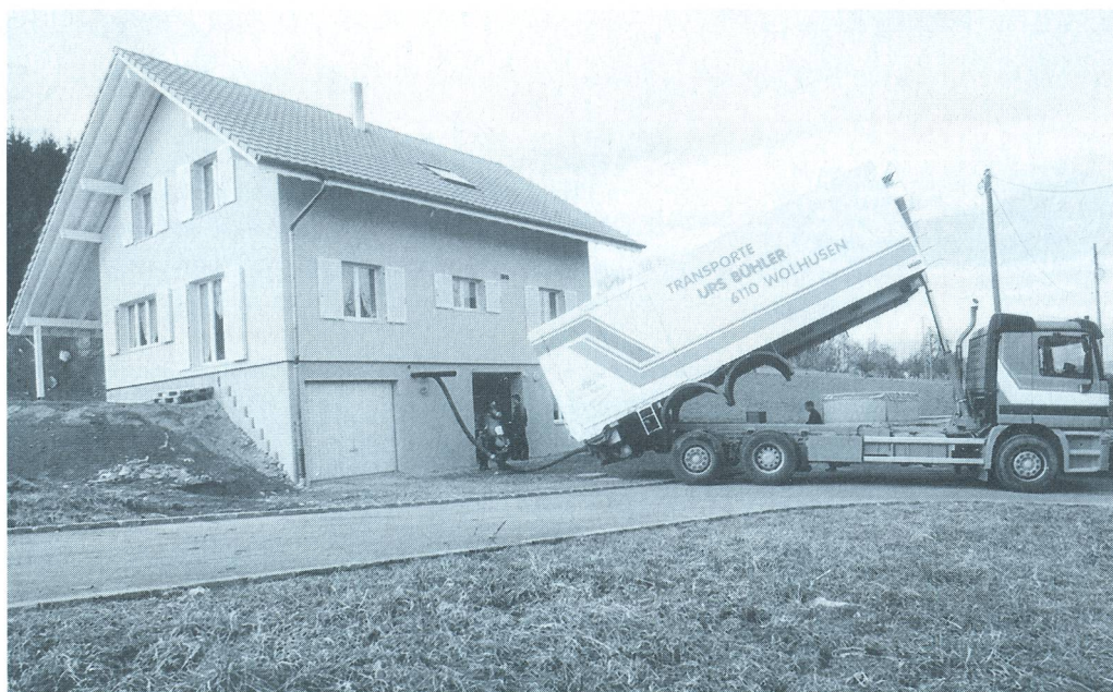
Concernant les chauffages centraux, la livraison est effectuée par des camions-citernes semblables à ceux utilisés pour le mazout.
