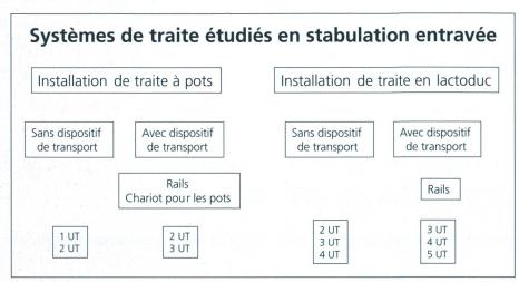
Fig. 2: En stabulation entravée, les procédés de traite se distinguent en deux types suivant le mode de transport du lait: installations de traite à pots et installations de traite en lactoduc.
