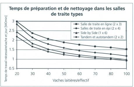
Fig. 6: En salle de traite, les travaux de préparation et de nettoyage dépendent essentiellement du nombre d'unités traveuses.
