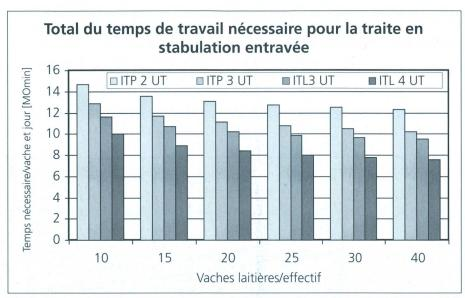
Fig. 8: En ce qui concerne la traite en stabulation entravée, on constate qu'il est possible de réaliser d'importantes économies de temps de travail en améliorant l'équipement technique.
