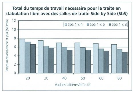
Fig. 10: Dans la salle de traite unilatérale Side by Side, le temps de travail nécessaire par vache et par jour se situe entre cinq et huit minutes.
