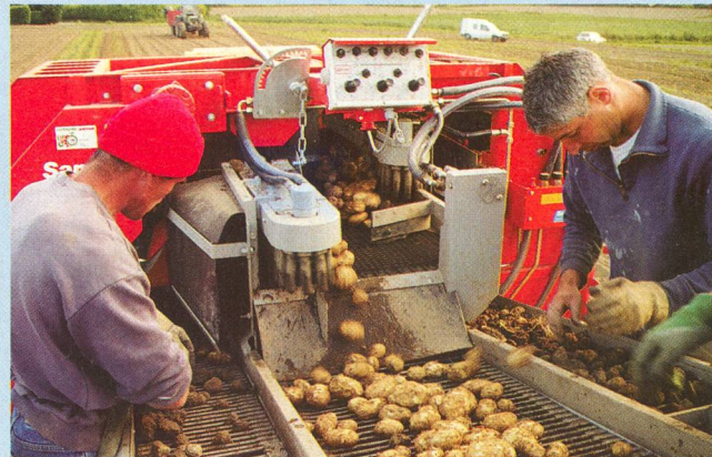
La récolteuse Offset 2000 se base sur la série Offset 97. Elle dispose d'une bande pour l'herbe plus large, d'une chaîne de tamisage plus longue et d'un conteneur roulant de 4 tonnes qui peut se vider jusqu'à 3,80 m de hauteur.
