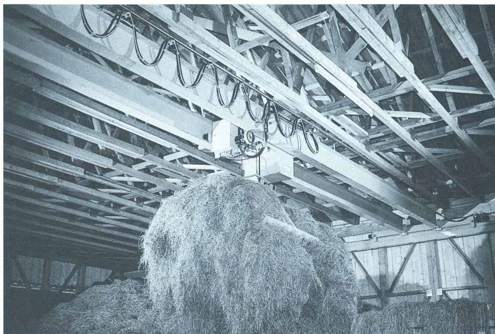
Pont roulant: une variante meilleur marché si les bâtiments sont construits en quadrilatères et sont relativement hauts.
