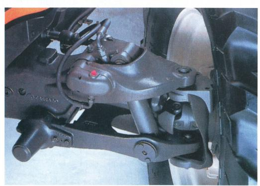
Option de la série ARES: le pont avant suspendu, équipé de Proactiv<sup>®</sup> (photo d'usine).
