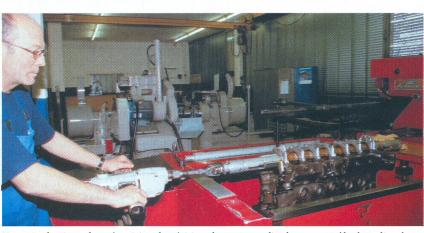
Un geste classique du mécanicien: la révision des moteurs diesel avec contrôle du palier de vilebrequin et...
