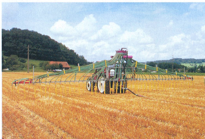
Distributeur par tuyau traîné de Hadorn, Leimiswil, BE. Intervalles de 30 cm entre les tuyaux; largeur de travail entre 12 et 15 m.
