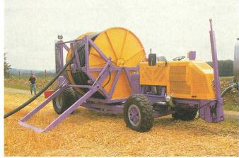
Prototype d'un enrouleur monté sur une remorque avec transmission bydrostatique permettant le déplacement au bord du champ. Puissance du moteur pour le bloc pompe 130 CV. 4×4, guidage télécommandé. Prototype de la maison Strebel, Waldbäusern, AG.
