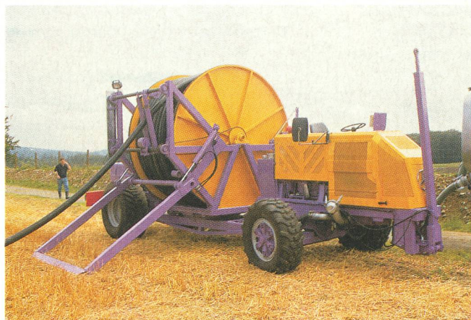
Prototype d'un enrouleur monté sur une remorque avec transmission hydrostatique permettant le déplacement au bord du champ. Puissance du moteur pour le bloc pompe 130 CV. 4x4, guidage télécommandé. Prototype de la maison Strebel, Waldbäusern, AG.
