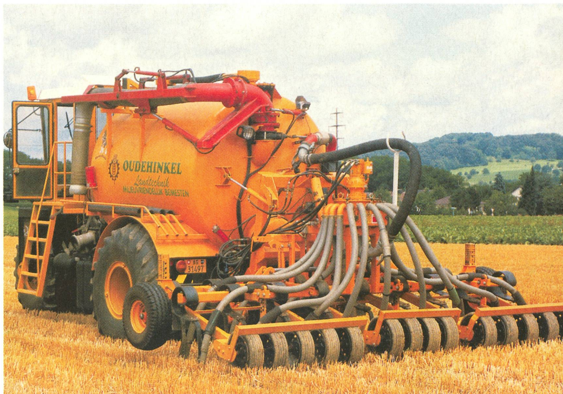
Venhuis VII 220: poids à vide 7 t, équipé d'un enfouisseur; débit adaptable à la vitesse d'avancement.
