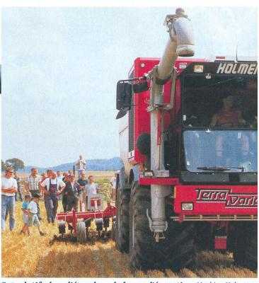
Superlatifs dans l'épandage de boues d'épuration: Machine Holmer, au motrice. Poids à vide 13 tonnes, poids pendant le travail 24 t, réglage de pneum tiques pour la route et les champs, moteur 420 CV, enfouissage entre 8–12 cm de profondeur, réglage de débit électronique.
