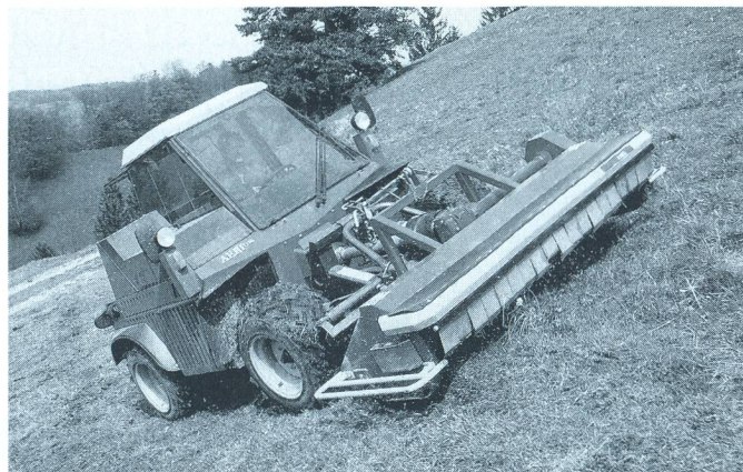
Le nouveau porte-outils et tracteur polyvalent Terratrac Aebi TT95 équipé d'un moteur turbodiesel de 82 CV et d'une transmission pour rouler à 40 km/h.
