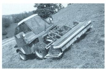
Le nouveau porte-outils et tracteur polyvalent Terratrac Aebi TT95 équipé d'un moteur turbodiesel de 82 CV et d'une transmission pour rouler à 40 km/b.
