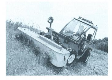
Une puissance de 42 CV et une cylindrée de 2,2 litres font de la Metrac G4 une faucheuse possédant une grande réserve de puissance qui permet de hautes performances à bas régime
