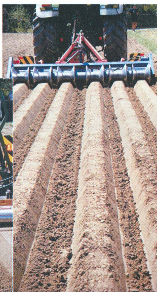
Butteurs avec intervalle de 50 cm.
