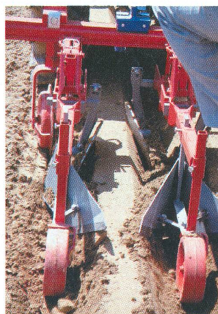
Herse spéciale pour buttes Bärtschi FOBRO qui libère les buttes des mauvaises herbes en un passage grâce à deux disques et reconstitue la butte immédiatement.
