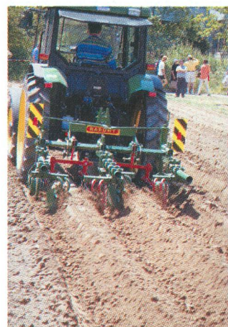
Avec la herse étoile, qui défait et reforme les buttes, ces dernières peuvent être travaillées efficacement.
