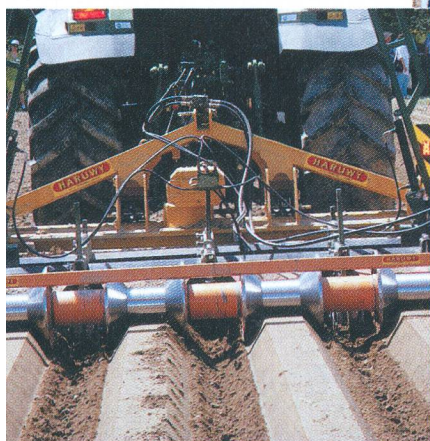
Butteurs avec intervalle de 75 cm.
