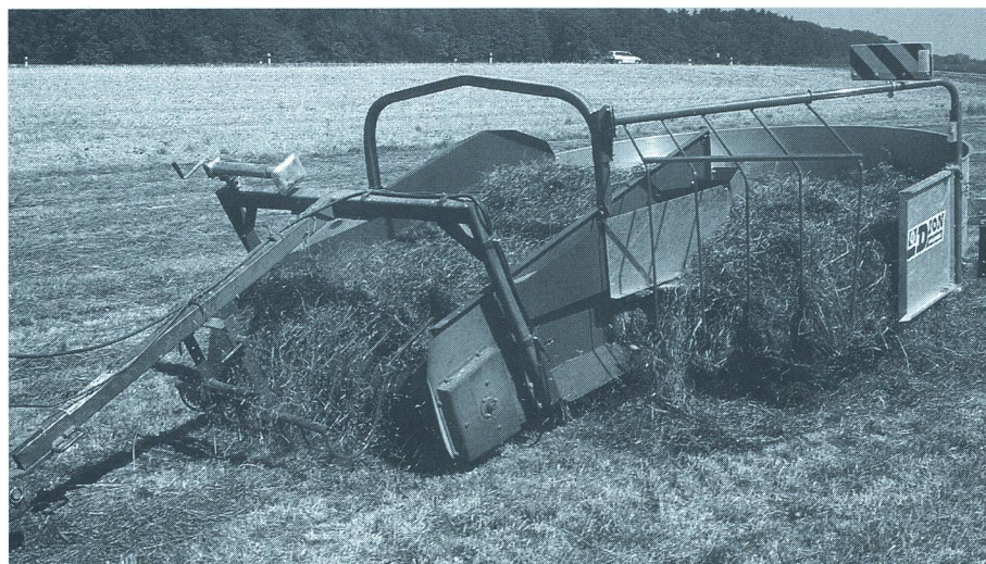
Fig. 1: Retourner le fourrage au lieu de le faner? Les résultats obtenus avec le retourneur d'andains sont très prometteurs, notamment lorsque les cultures ont une forte tendance aux brisures.
