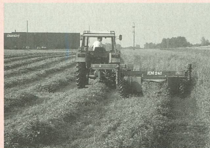
Fig. 13: Le succès du retourneur d'andains commence par la fauche. Le dispositif de coupe doit être pourvu d'un conditionneur et former des andains réguliers. Les chaumes doivent mesurer au minimum 6 cm. Il est préférable de faucher la parcelle la veille, pour que le sol entre les andains puisse sécher complètement jusqu'à midi.
