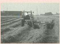
• **Conditionneur:** Son utilisation est très recommandée. En outre, il est préférable d'utiliser des conditionneurs à rouleaux que des conditionneurs à fléaux ou à dents.
