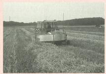
• **Dispositif de coupe:** Il faut que la largeur de coupe soit supérieure à 2,3 m, pour que les andains atterrissent sur le sol sec lorsque la machine les retourne et pour que les performances à la surface soient satisfaisantes.
