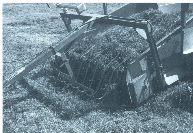
Fig. 2: Le peigne placé au-dessus du pick-up pour retenir le fourrage a pour but de disposer ce dernier régulièrement et avec ménagement sur le tapis roulant.
