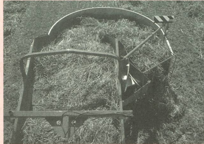
Fig. 12: La machine doit être réglée de telle manière que le tapis roulant en caoutchouc et le disque rotatif puissent être alimentés le plus régulièrement possible.
