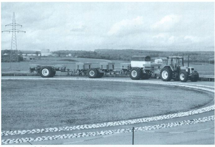
Avant qu'un pneu soit distribué sur le marché, il doit passer des tests aussi rigoureux que subtils. Test de longue durée chez Goodyear au Luxembourg.
