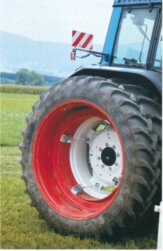
Les roues jumelées ou les pneus larges sont autorisés pour les véhicules agricoles jusqu'à une largeur de 2,55 m.
