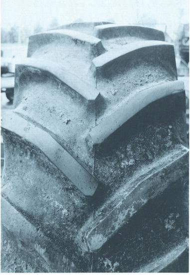
Usure typique: des pneus trop gonflés provoquent de grandes dégradations au milieu du pneu.
