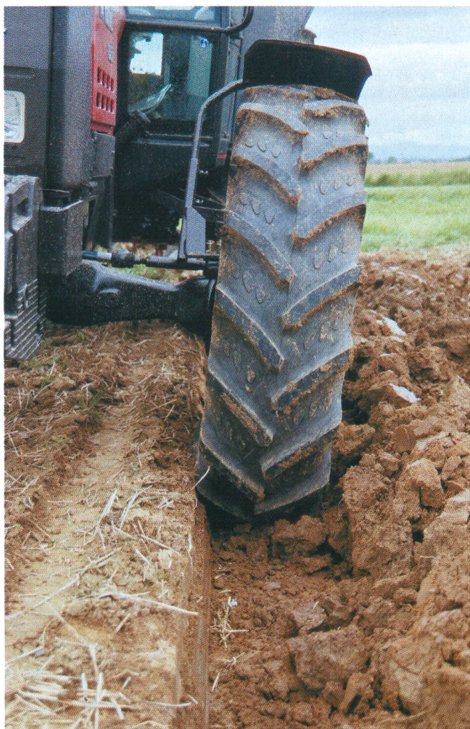
Un pneu «vert» Kleber. Le profil épouse le sillon. Les grandes roues aux pneus étroits diminuent la pression au sol et la résistance de roulement.
