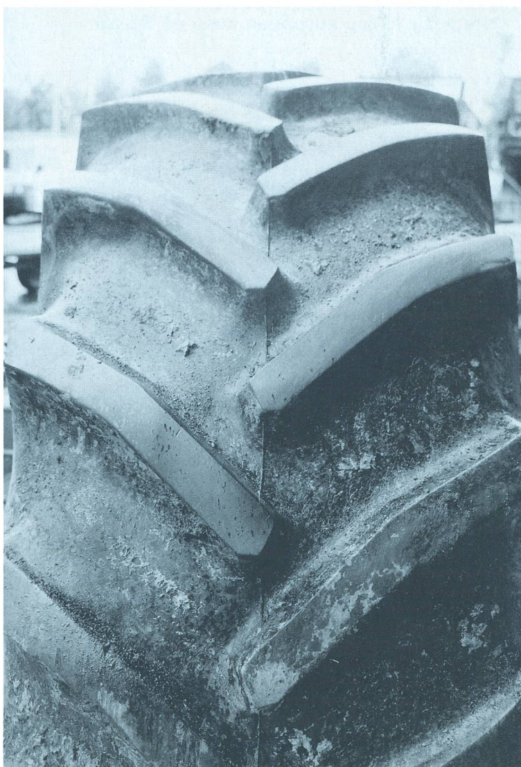
Usure typique: des pneus trop gonflés provoquent de grandes dégradations au milieu du pneu.
