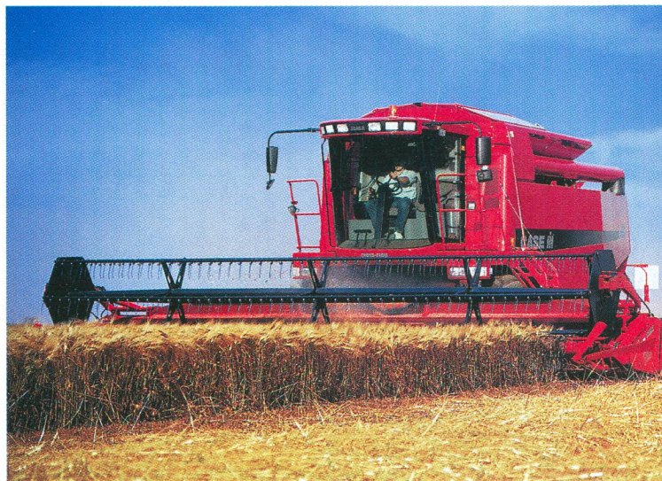
CF 80 (Cross Flow) avec système de battage intensif, six secoueurs et moteur de 300 CV.
