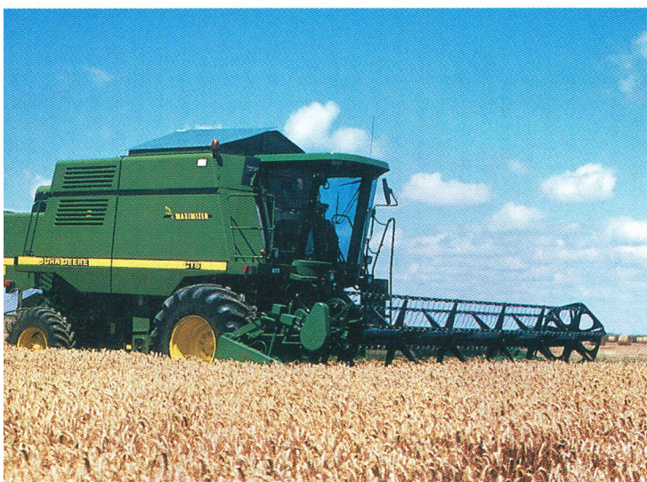
La CTS avec un tambour de battage de 660 mm de diamètre et de nombreux détails améliorés.
