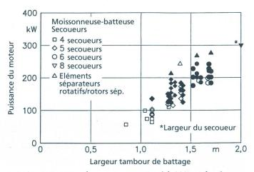
La puissance moyenne des moteurs a augmenté de 20 % ces dernières années. Cette augmentation va de pair avec celle des secoueurs montés sur les moissonneuses-batteuses. Dans la catégorie «puissance supérieure», le nombre de modèles dotés de systèmes de séparation rotatifs augmente.
