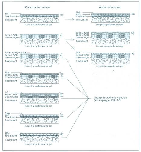
Fig. 8: Structure possible des revêtements de dalles de silos pour les constructions neuves et les réparations.
