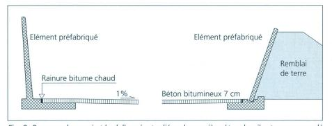
Fig. 9: Pour que la paroi et la dalle soient reliées de manière étanche, il est recommandé de ne pas arrêter le revêtement au pied de la paroi, mais de le faire passer par dessus. Elément préfabriqué dégagé à gauche et élément préfabriqué type Traunstein à droite.
