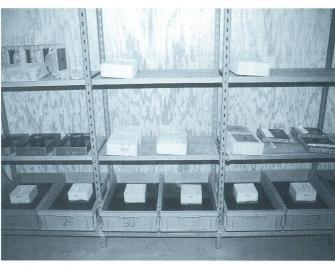
Fig. 3: Parallèlement à l'essai sur la machine, des échantillons de béton et d'asphalte ont été plongés en permanence dans le jus de fermentation.
