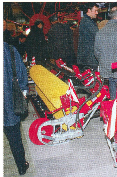
Redécouverte d'un ancien principe: les petits constructeurs des régions alpines occupent un créneau avec les dispositifs de fauche à bande de coupe.
