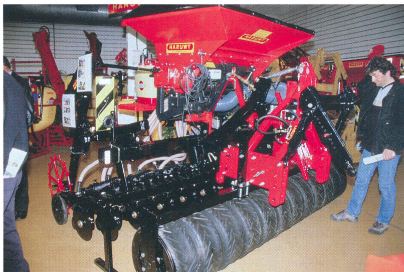
Combinaison de semis compacte, contrôle de la profondeur, espace interligne réduit et hautes performances: la technique de semis moderne réunit les atouts de la préparation intensive du lit de semences et du semis direct.
