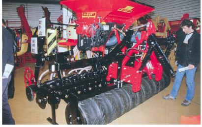
Combinaison de semis compacte, contrôle de la profondeur, espace interligne réduit et hautes performances: la technique de semis moderne réunit les atouts de la préparation intensive du lit de semences et du semis direct.
