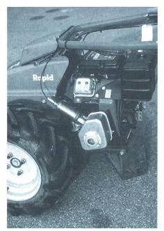
Fig. 7: Le catalyseur avec sonde lambda intégrée est placé avant le silencieux monté en série. Les gaz d'échappement doivent passer si possible directement dans le catalyseur sans avoir été refroidis au préalable.
