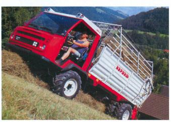
② Chez **Reform** (Agromont), l'argument précédent émis par Schiltrac selon lequel le délestage de l'essieu arrière est simulé est obsolète. En réalité, et la FAT le confirme également, le couple (réduit en plus par une transmission planétaire) ne correspond qu'à une fraction de ce qu'il est sur le modèle par rapport à la charge sur l'essieu. Sur le plan de la
