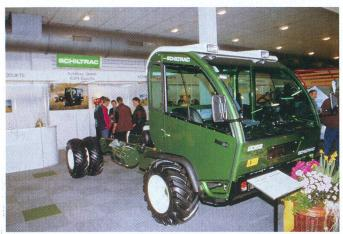
① Chez Schiltrac Construction de véhicules, Buochs NW, cette problématique est centrale et orientée clients. Ce constructeur construit son transporteur sur la base d'un châssis breveté comprenant une double poutrelle. Le moteur se situe sur la partie postérieure du châssis, à moitié sous la cabine, de telle manière que le couple de rotation pour la traction et celui des
